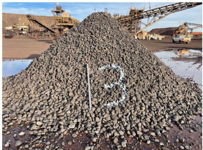
Figure 14. Butcherbird ore post DMS processing
