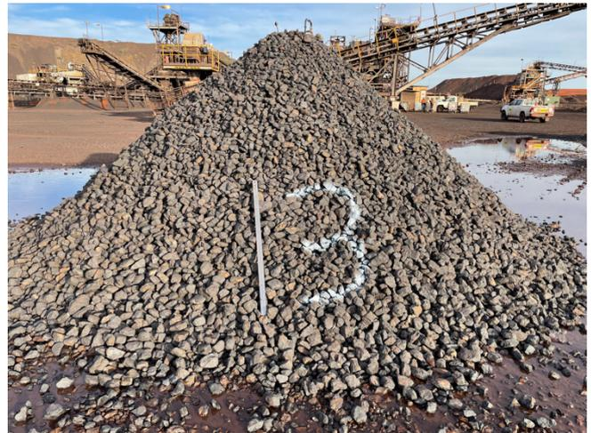
Figure 4. Butcherbird ore post DMS processing
